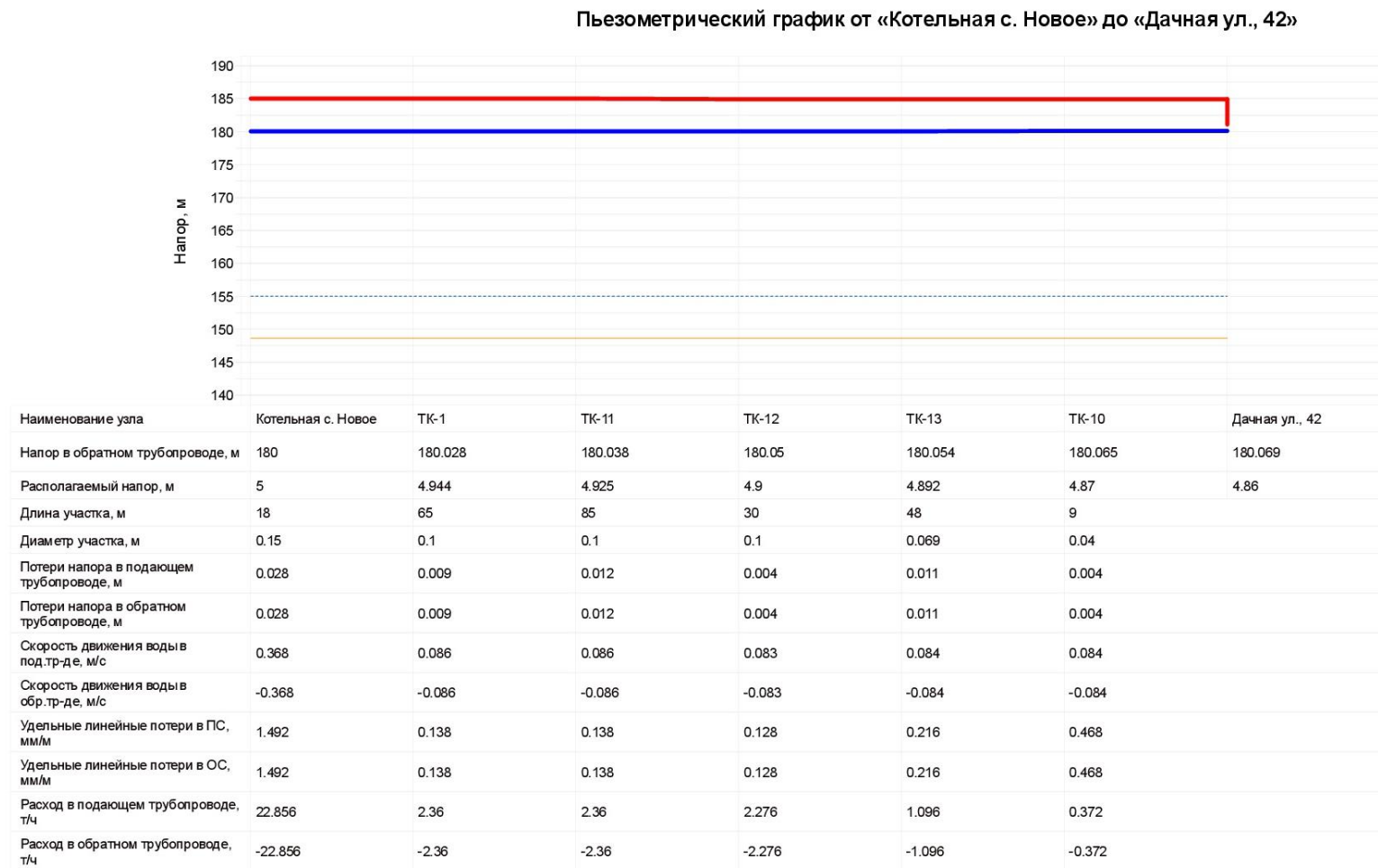
Рисунок 0.23 – Пьезометрический график от котельной с.Новое до д.42 по ул. Дачная
